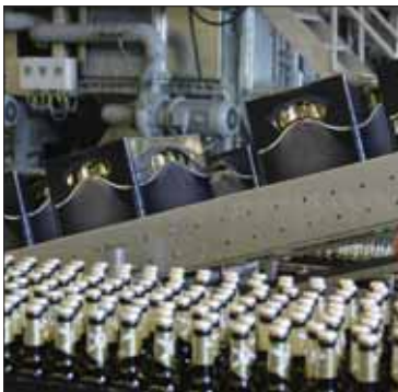
Bira fabrikasının üretim tesisinde kayar raylar
