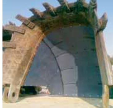
dehoplast®superlining'den kepçe kaplaması
